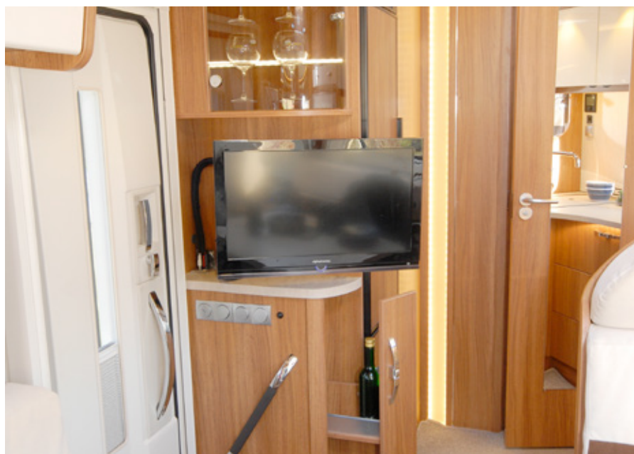
Für einen sicheren Halt des Fernsehers sorgen spezielle Befestigungsarme – die Ausrichtung erfolgt über eine Schiebe- oder Schwenkmechanik
