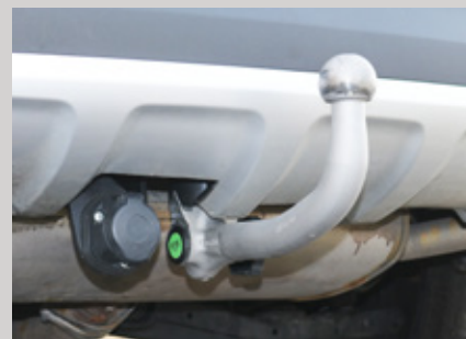
Passabel: Der abnehmbare Kugelkopf und die schwenkbare Steckdose sind gut zu bedienen
