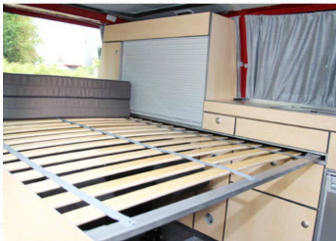
Nicht weniger Erfahrung hat Köhler, dessen separater Lattenrost bei Nichtgebrauch als Abdeckung über den Stauraum hinter der Sitzbank dient
