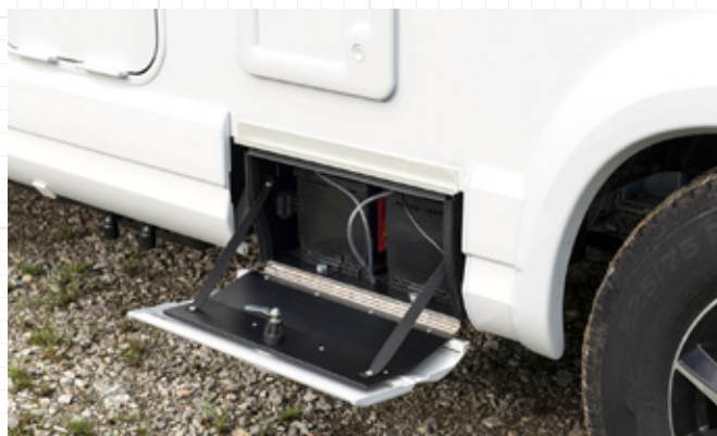
Das praktische Batteriefach des Knaus ist von außen gut zugänglich
