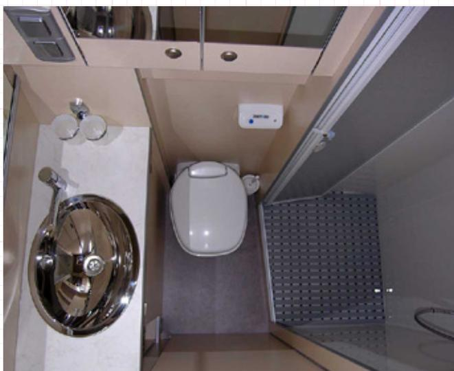
Die Dusche im HRZ besteht aus einer nahtfreien, einteiligen GFK-Kapsel
