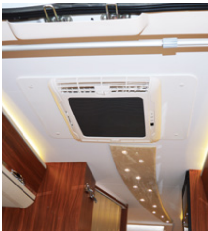
Gut ge-Dacht: Adapter für Mini-Heki- oder Lüfter-Einbau bei Free Living
