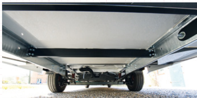
Bei der Sicht unter den Hobby ist der GFK-Boden gut zu erkennen
