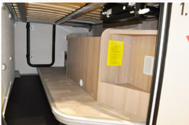
Ein Blick in die Heckgarage des Challenger zeigt den höhenverstellbaren Lattenrost und die in die Garage ragenden Schubladen unter dem Heckbett. Beides wird nicht von alle Herstellern angeboten
